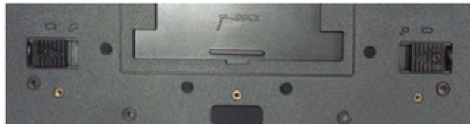
Pasadores de liberación de la batería en posición bloqueada
